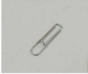
写真7 電極とするために工夫したクリップ
