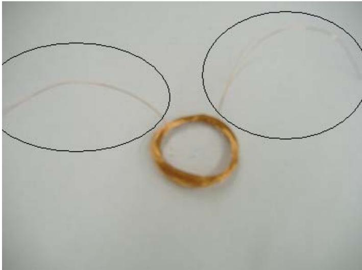
写真 2-4 コイルのエナメルを削る
