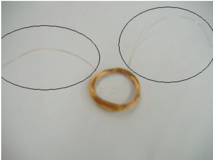
写真 2-4 コイルのエナメルを削る
