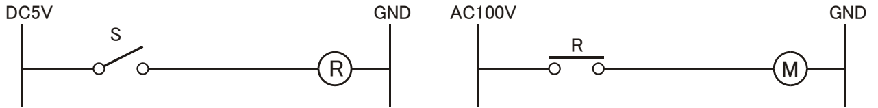
図 11 制御用電源と出力電源が異なる回路の制御例
